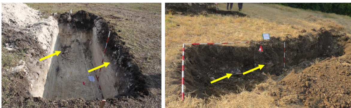
Imagen No. 8 Verificación de anomalías mediante excavación.
