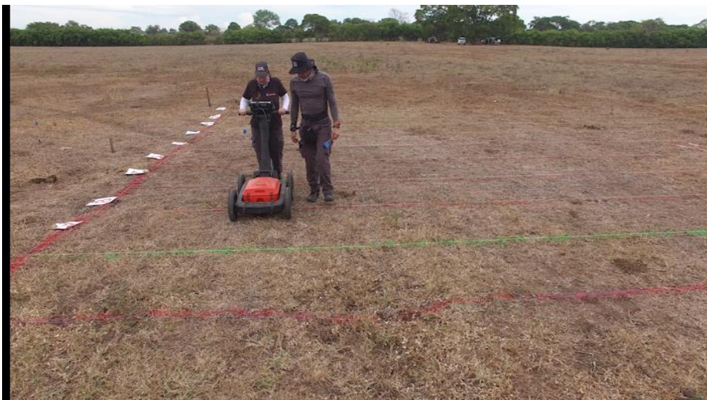
Imagen No.4 Búsqueda con GPR por franjas
